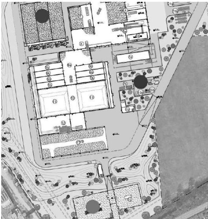
Localizzazione delle sorgenti emissive in progetto (in blu il biofiltro, in rosso la caldaia, in verde l'off-gas)
